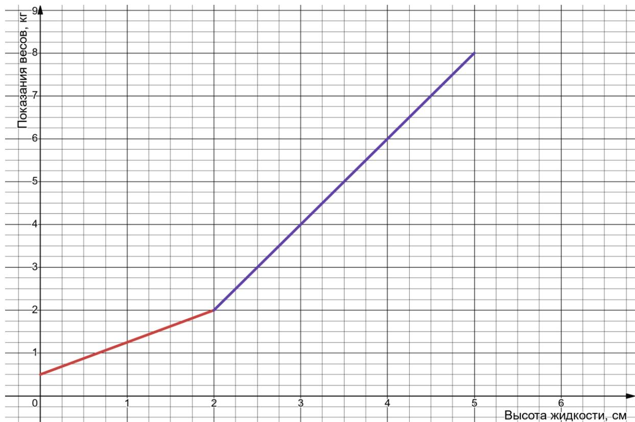
**Возможное решение:** Проанализируем график. Первый участок — это первая жидкость. Ее плотность: (+1 балл)
