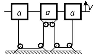
**Возможное решение:** При повышении уровня жидкости центральный куб будет погружаться в большей степени, чем крайние, так как к нему приложена удвоенная сила натяжения нити, которая возрастает по мере погружения кубов на величину дополнительной выталкивающей силы (+1 балл).
